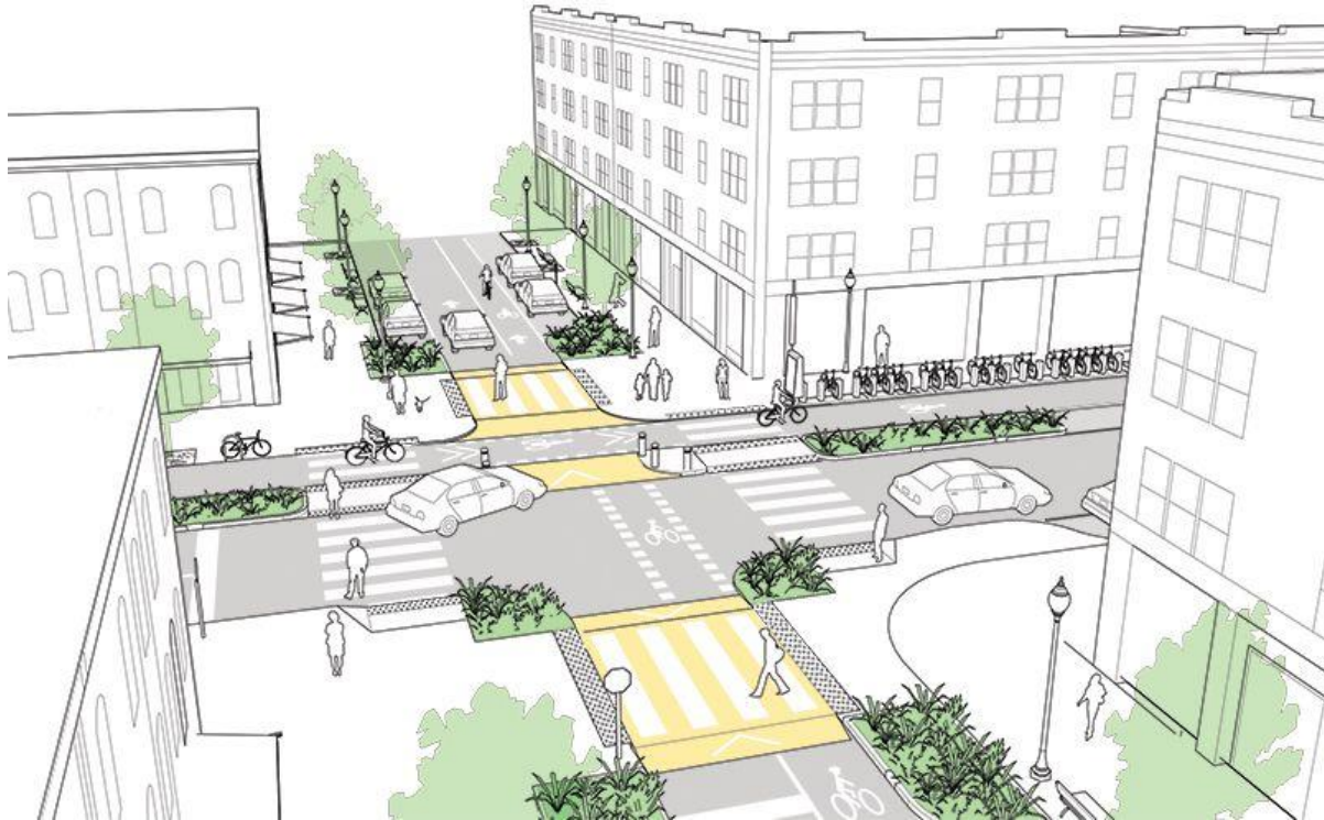
Figura 3 – Faixa elevada para pedestres
